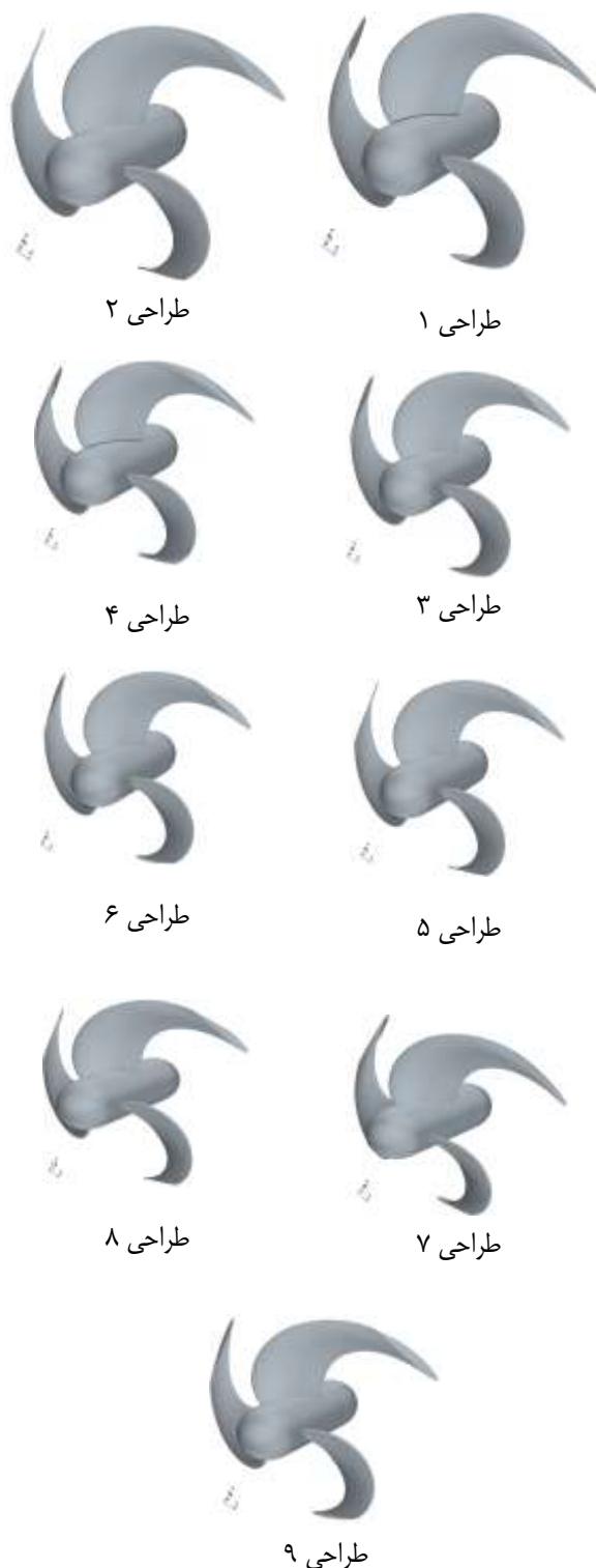
شکل ۱۱. شماتیک پروانه‌های طراحی شده پیشنهادی با روش تاگوچی
