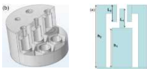
شکل ۱. الف) نمای جانبی تشدیدگر هلمهولتز دوگانه (ب) نمای سه‌بعدی تشدیدگر هلمهولتز دوگانه [۱]
