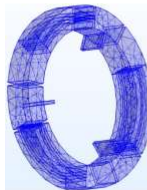
شکل ۸. شبکه بندی هرمی چهاروجهی تشدیدگر هلمهولتز دوگانه
