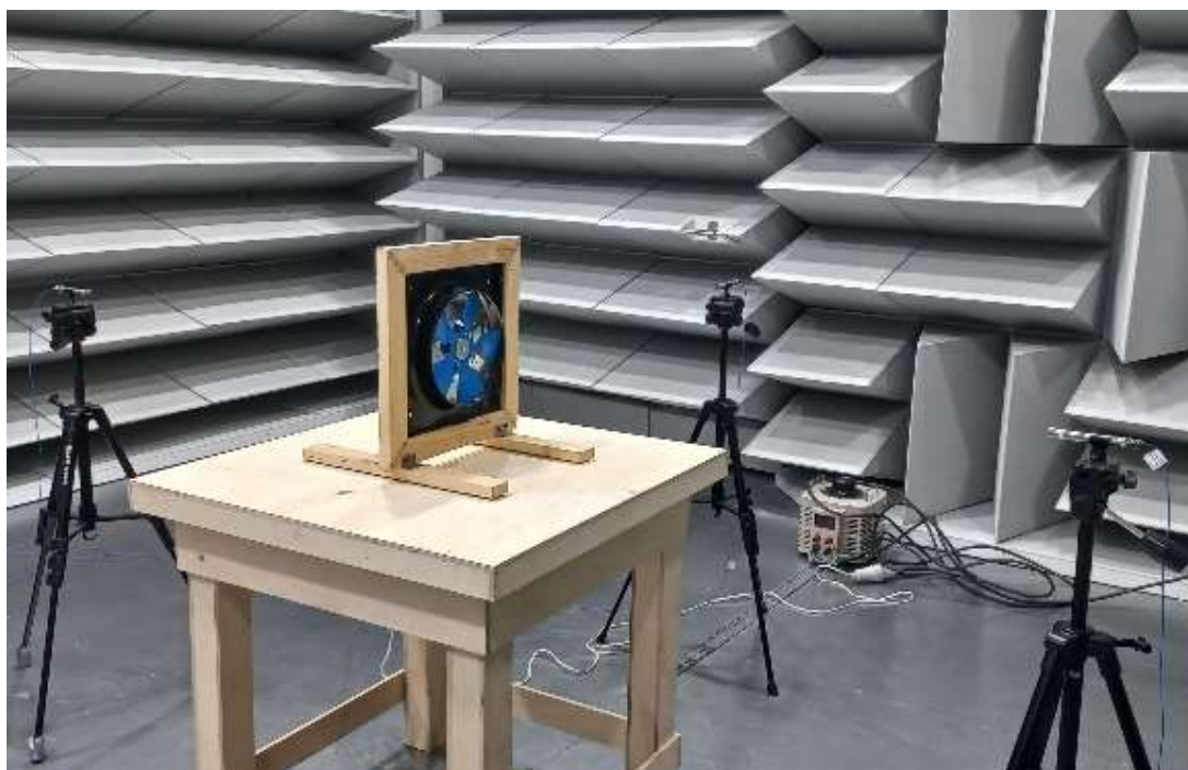
شکل ۲: چیدمان میکروفون‌ها در فاصله یک متری در اطراف دمنده
