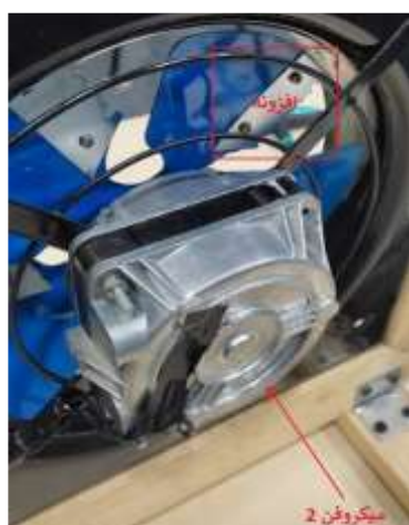
شکل ۲: چیدمان میکروفون‌ها در فاصله یک متری در اطراف دمنده
