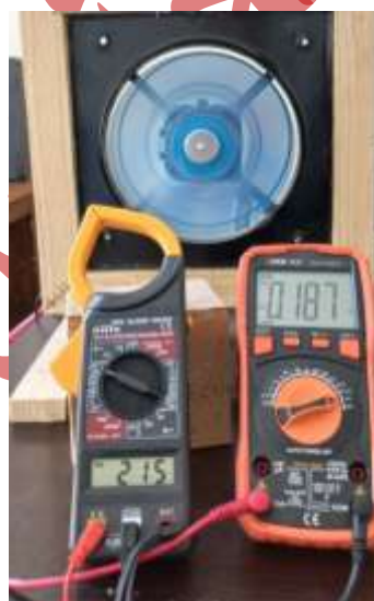
شکل ۴: اندازه گیری توان الکتریکی دمنده
