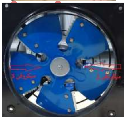
شکل ۳: جهت قرارگیری میکروفن‌ها نسبت به دمنده
