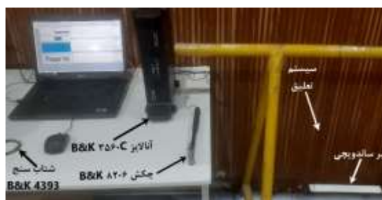
شکل ۴. پیکربندی آزمون مودال ضربه چکش
