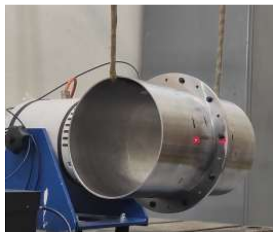
شکل ۶. پوسته پیچ‌شده استوانه‌ای فلنچی تحت آزمون مودال.
