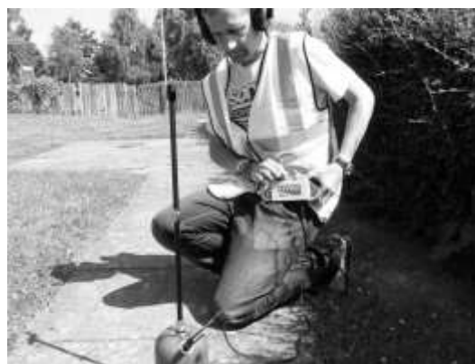
شکل ۴. دستگاه شنود زمینی برای تعیین دقیق محل نشت [۱۷]
