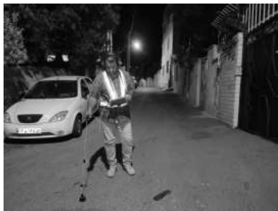
شکل ۲. نحوه استفاده از ژئوفون در نشت‌یابی شبکه توزیع [۱۵]
