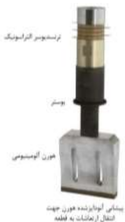
شکل ۳. ترانسدیوسر، بوستر و هورن استفاده شده برای اعمال
