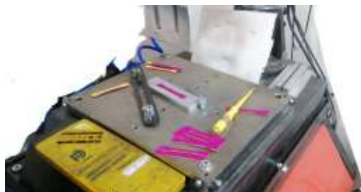
شکل ۵. بسته شدن فیکسچر به میز دستگاه و قرارگیری نمونه
