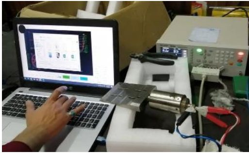
شکل ۲۴. چیدمان آزمون امپدانس مجموعه ترنسدیوسر و تیغه برشی فراصوتی ۴۰ کیلوهرتز
