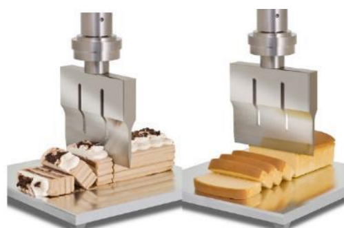
شکل ۱. کاربرد چاقوی برش فراصوتی در برش کیک [۱]
