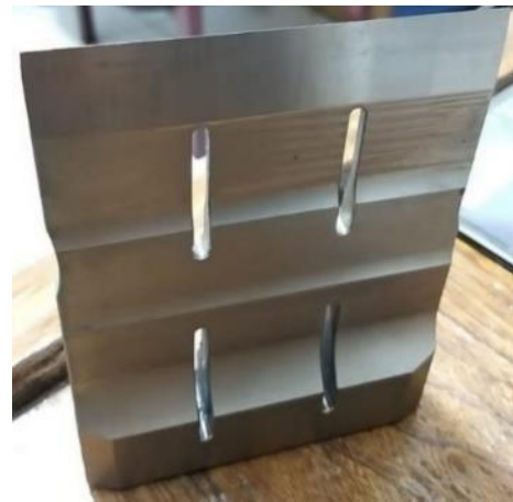
شکل ۲۳. نمونه هورن برشی فراصوتی ساخته شده از جنس Ti-6Al-4V
