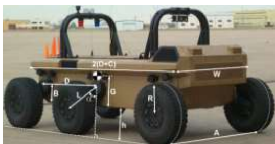
شکل ۹. نمایش پارامترهای هندسی خودرو [۱۰]
