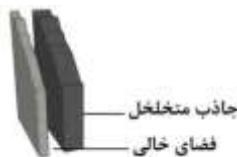
شکل ۸. تعبیه جاذب‌های متخلخل با فاصله از دیوار، به‌جهت افزایش ضریب جذب در بسامدهای پایین.
