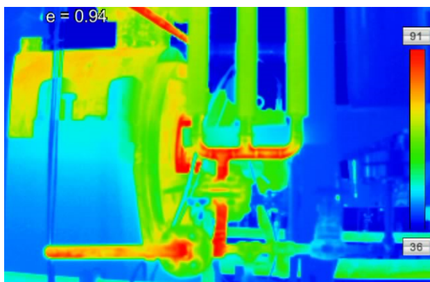
شکل ۱۹. تصویر حرارتی خطهای سیل فلش مکانیکال سیل (DE)
