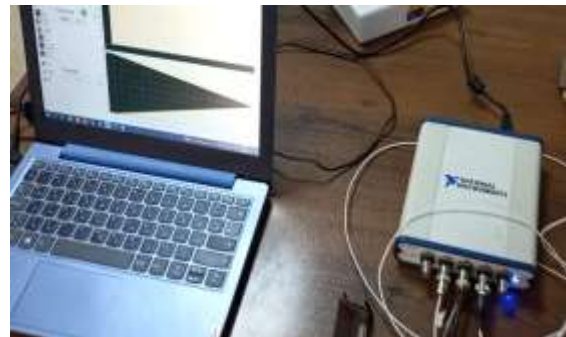
شکل ۴. سیگنال خروجی میکروفون توسط یک کارت داده برداری ساخت شرکت National Instruments
