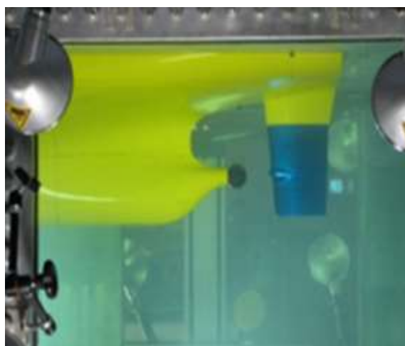
شکل ۲۶. آزمایش پیش‌بینی سطح سر و صدای یک کشتی مقیاس شده در تونل کاویتاسیون [۴۷]
