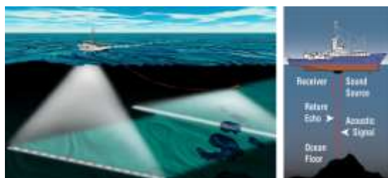
شکل ۲۵. تصویرسازی از پژواک‌سنجی (سمت راست) و تصویری از سونار چند پرتویی از یک کشتی و یک دستگاه یدک‌کش برای نقشه‌برداری از کف دریا (سمت چپ) [۴۶]
