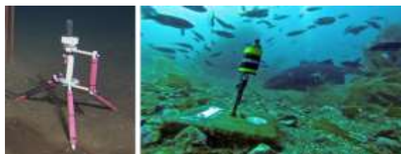
شکل ۲۴. تصاویر هیدروفون فرکانس پایین مستقر در بستر دریا در سایت رصدخانه [۴۵]
