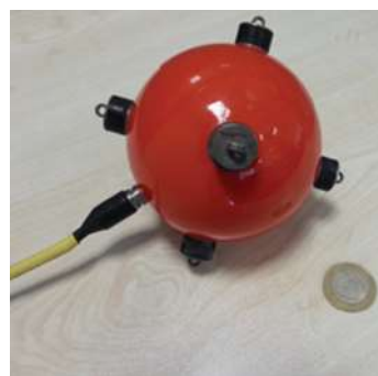
شکل ۹. حسگر آرایه برداری مورد استفاده در پژوهش [۱۹]
