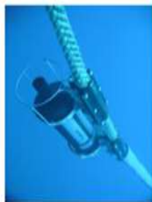
شکل ۲۳. باران‌سنج صوتی متصل به یک خط پهلویی [۴۵]
