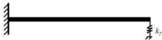
شکل ۲. تیر نازک با تکیه‌گاه گیردار-الاستیک.
