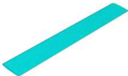
شکل ۴. شبکه‌بندی نهایی سیستم
