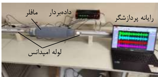
شکل ۱۰. تجهیزات آزمایشگاهی و مافلر طراحی شده متصل به لوله امپدانس
