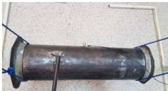
شکل ۴. آزمون چکش مودال بر روی پوسته استوانه‌ای
