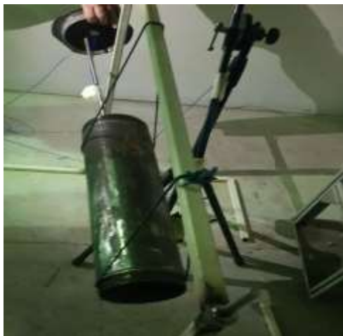
شکل ۷. نحوه قرار گیری میکروفون در داخل پوسته
