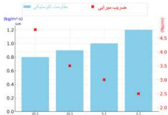
شکل ۵. نمودار امپدانس آکوستیکی و ضریب میرایی را برای چهار نسبت مختلف PDMS
