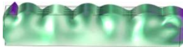
شکل ۳. خروجی شبیه‌سازی امواج سطحی ایستا بر روی ویفر پیزوالکتریک با ضخامت ۵۰۰ میکرون
