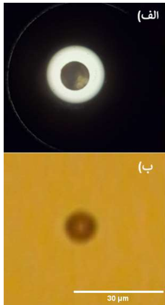
شکل ۹. میکرو ربات‌های پلی‌استایرنی مورد استفاده در تست‌های تجربی
