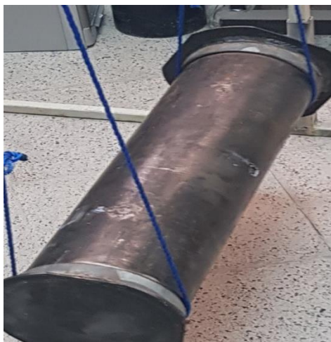
شکل ۲. نمونه پوسته استوانه‌ای ساخته شده تحت آزمایش
