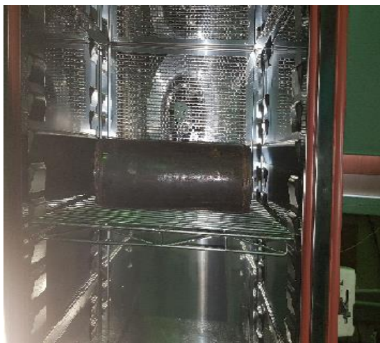
شکل ۸. گرم نمودن پوسته تا دمای ۸۰ درجه سانتی‌گراد
