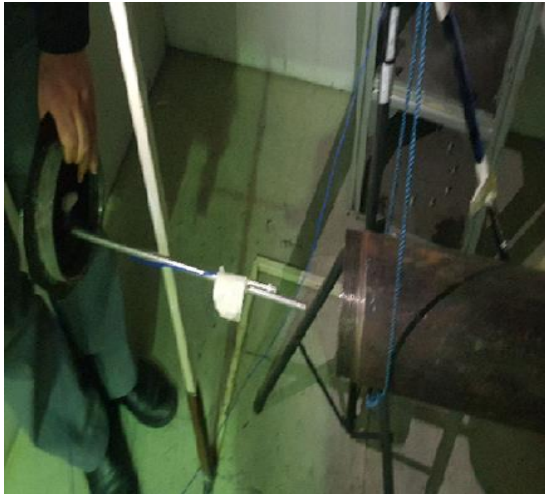
شکل ۷. محل نصب میکروفون بر روی درپوش انتهایی پوسته
