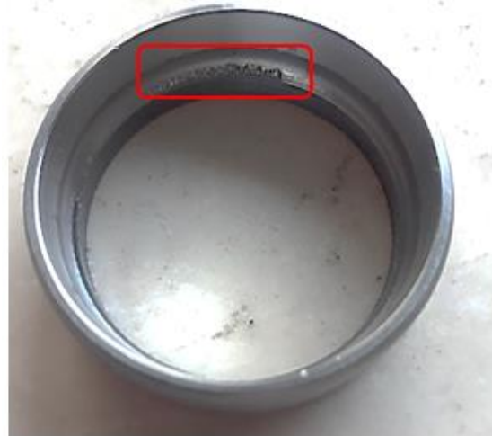
شکل ۷. خرابی مشاهده شده برای حلقه بیرونی یاتاقان در انتهای آزمون
