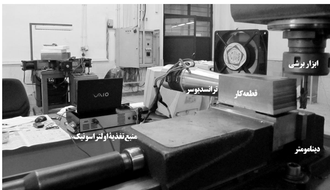
شکل ۲. تنظیم تجربی عملیات کنارتراشی برای آزمایش‌های فرزکاری معمولی و اولتراسونیکی در حالتی که پیشروی ابزار عمود بر جهت ارتعاش است
