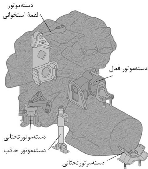
شکل ۲. اتصال موتور و شاسی به کمک انواع دسته‌موتور [۲]
