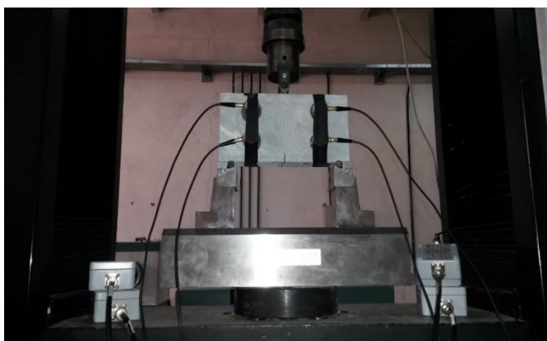
شکل ۹. انجام آزمایش خمش سه‌نقطه‌ای و برداشت هم‌زمان داده‌های آوایی توسط حسگرها
