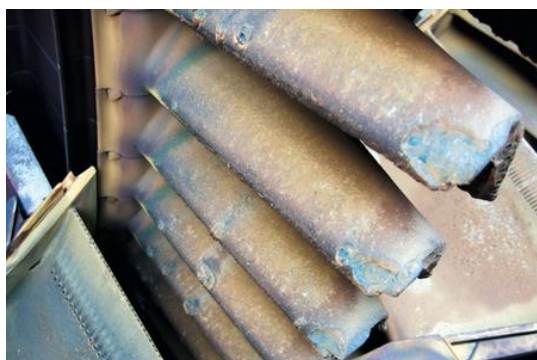
شکل ۶. شکست نوک پره‌ها به‌دلیل کار در دمای بالا
