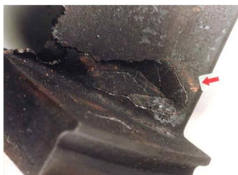
شکل ۵. ترک در ریشه پره در اثر کارکرد زیاد
