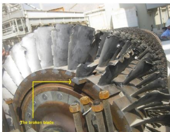
شکل ۳. شکست پره در اثر کارکرد زیاد [۴۲]
