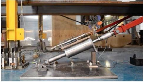
شکل ۱۵. میراگر مغناطیسی مقیاس بزرگ مورد استفاده در ساختمان‌ها [۱۱۴]
