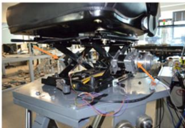
شکل ۱۱. میراگرهای جریان مغناطیسی به کار رفته در صندلی
