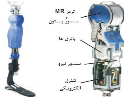
شکل ۱۳. زانوی مصنوعی که در آنها از ترمز MR استفاده شده است [۱۰۶-۱۰۸].
