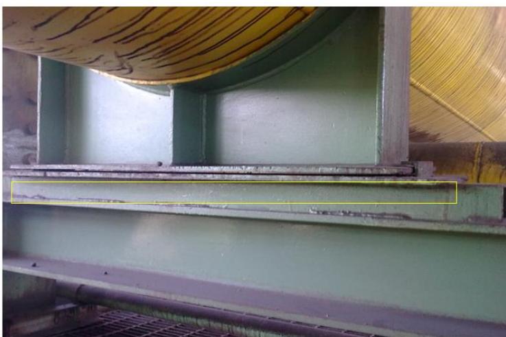
شکل ۱۹. وجود فاصلہ بین تکیہ گاہ و سازه کمپرسور ۵۱
