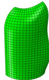
شکل ۱۲-ت. شکل مود چهارم، پیل متصل کروی-استوانه‌ای
