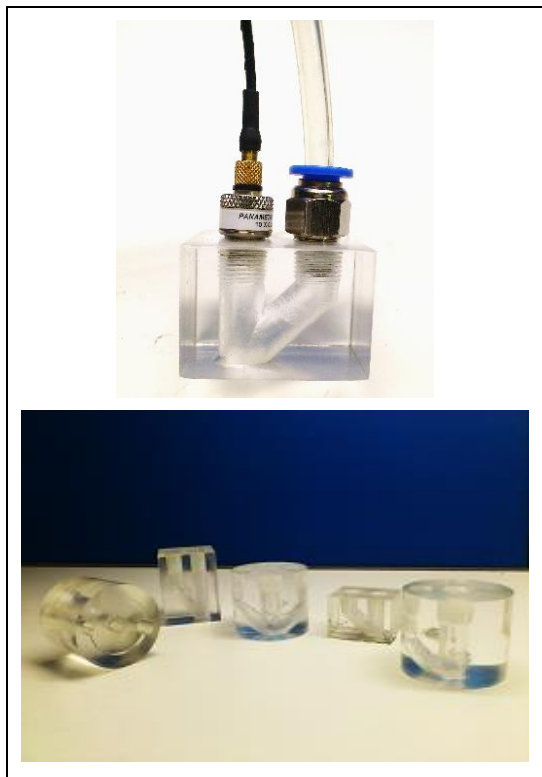
شکل ۳. تصویری از سیستم حباب‌ساز طراحی شده برای بازرسی سطوح انحنادار
