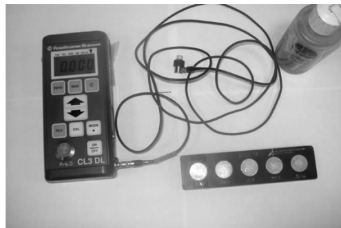
شکل ۱. لوازم آزمون اولتراسونیک برای کنترل کیفیت اتصال لحیم
