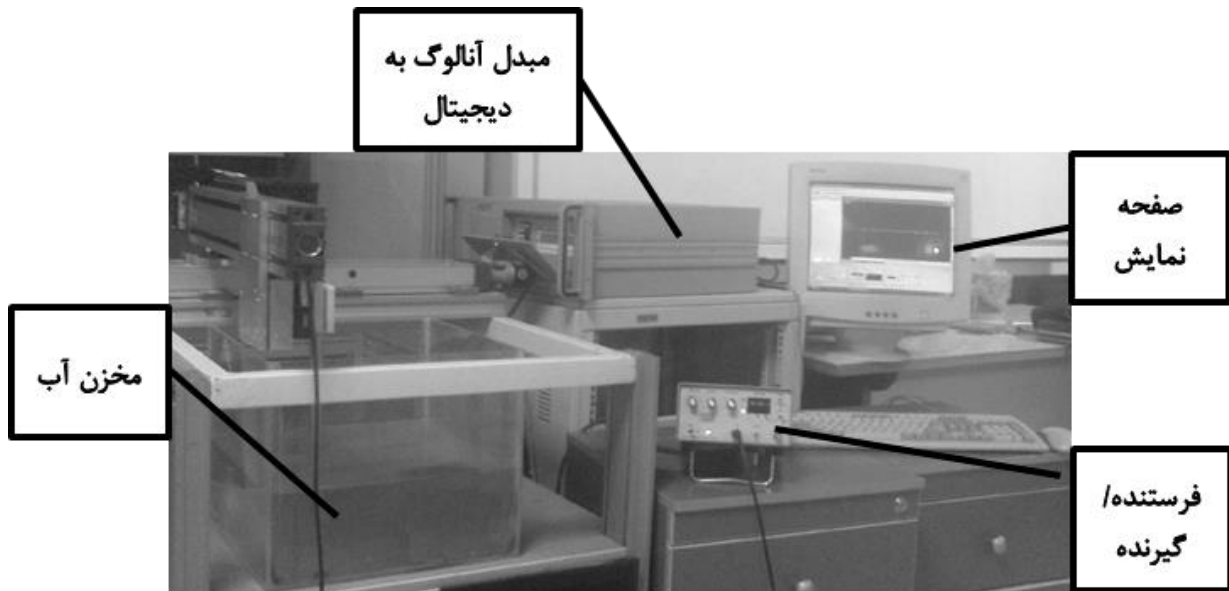
شکل ۱. چیدمان آزمون غیرمخرب به روش بازتابی و غوطه‌وری
