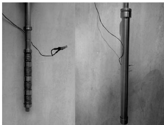
شکل ۲. نمونه آزمایشگاهی میراگر مغناطیسی کنترل‌پذیر
