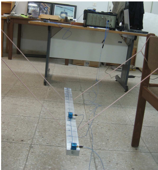
شکل ۲. آزمایش مودال تیر آلومینیومی
