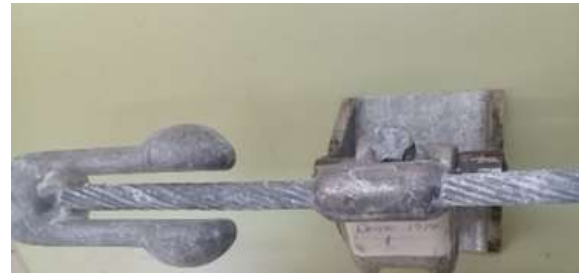
شکل ۴. ذرات نمک رسوب شده در بین رشته‌های سیم کابل استاک بریج دمپر
