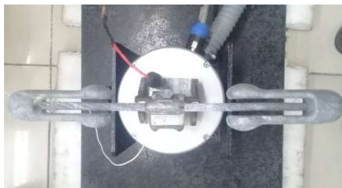
شکل ۲. انجام تست پاسخ فرکانسی استاک بریج دمپر با استفاده از شیکر
