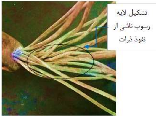
شکل ۵. لایه‌های رسوب شکل گرفته بر روی رشته سیم‌های داخلی کابل جاذب
