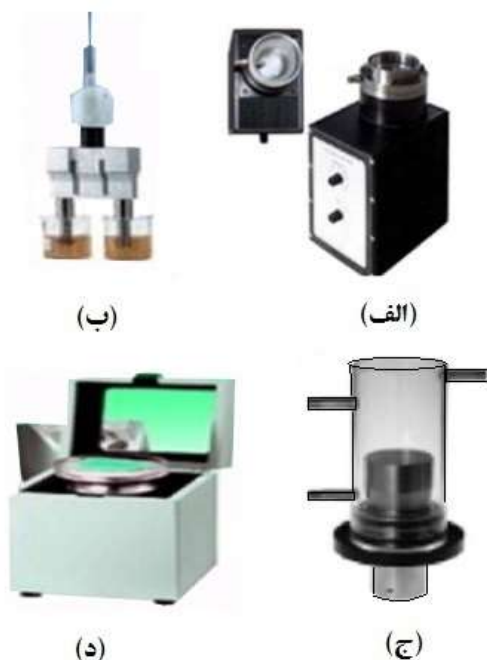
شکل ۱. نمایی از دستگاه تولید امواج فراصوت الف) مولد فراصوت، ب) پروب دو تایی، ج) هورن‌های فنجانی و د) هورن‌های میکرو صفحه [۲۱].
