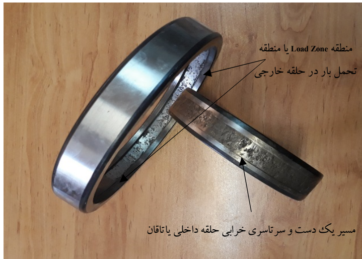
شکل ۹. حلقه داخلی و خارجی یاتاقان با علایم خستگی ناشی از بیش بار
