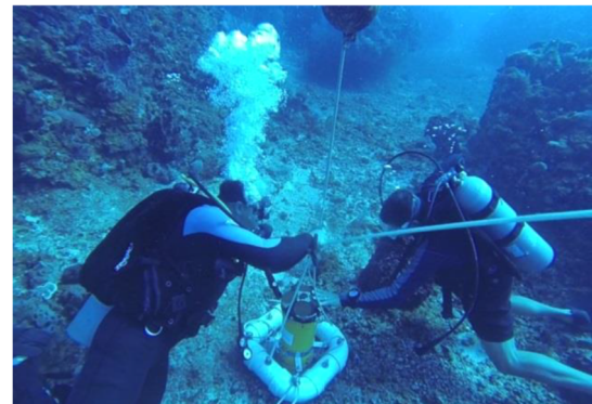
شکل ۳. نحوه‌ی قرارگیری ای‌دی‌سی‌پی‌ها در کف محیط آبی
