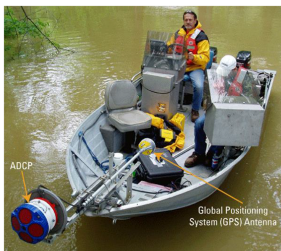
شکل ۴. استفاده از روش ای‌دی‌سی‌پی متحرک جهت اندازه‌گیری سرعت و دبی جریان [۱۳]
