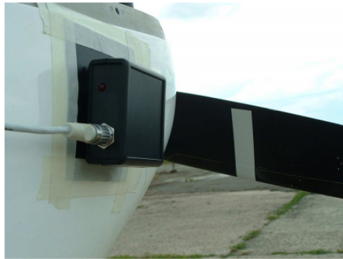
شکل ۲۱. نمونه‌ای از نصب سنسور تاکومتر و نوار انعکاس [۱۱]
