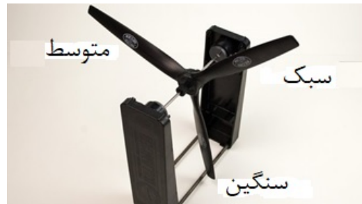
شکل ۹. موقعیت قرارگیری پره‌ها در ملخ نابالانس سه پره
