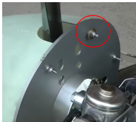
شکل ۲۳. نصب جرم آزمایشی
