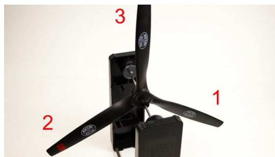
شکل ۱۰. پس از بالانس کردن پره متوسط و سنگین
