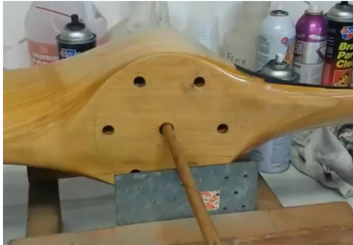
شکل ۱۲. حفره‌هایی جهت انجام بالانس هاب توسط سازنده قرار داده شده
