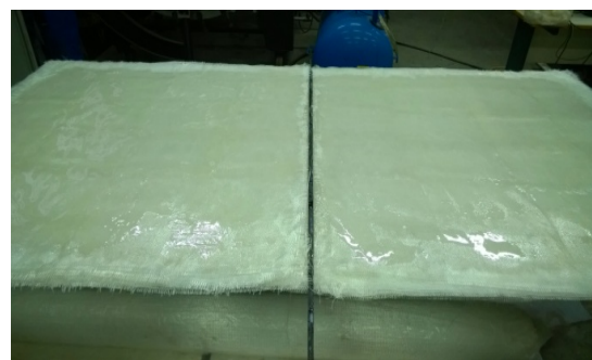
شکل ۱. مراحل ساخت ورق کامپوزیت مورد استفاده در آزمایش انعکاس ضربه
