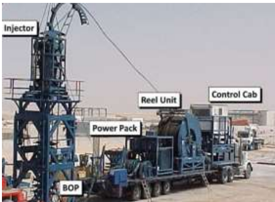
شکل ۱. بخش‌های مختلف دستگاه لوله مغزی سیار [۳]
