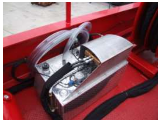
شکل ۱۲. دستگاه پایش وضعیت لحظه‌ای لوله مغزی سیار با روش آلتراسونیک (ARGUS)
