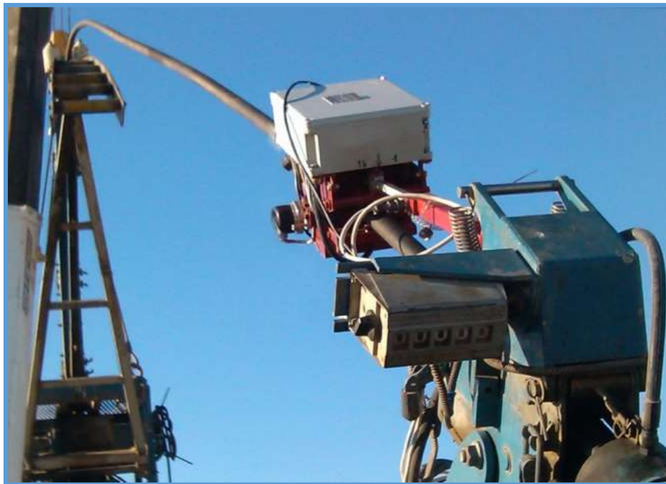
شکل ۱۸. محل قرار گرفتن دستگاه جهت اندازه‌گیری به صورت آنلاین در خروجی قرقره
