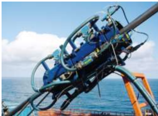
شکل ۱۳. دستگاه پایش وضعیت لحظه‌ای لوله مغزی سیار با روش نشت شار مغناطیسی (ACIM)
