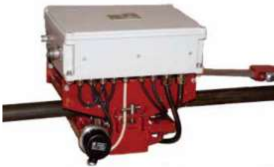
شکل ۱۶. دستگاه پایش وضعیت لحظه‌ای لوله مغزی سیار با روش ادی کارنت (DCT)
