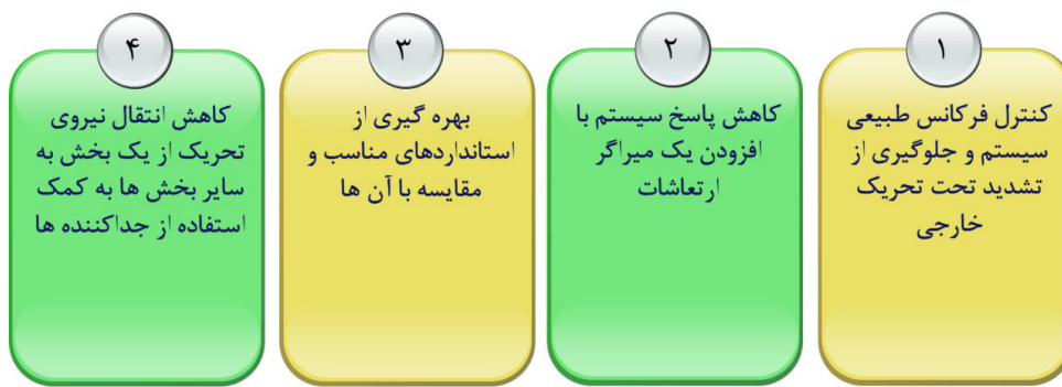
شکل ۱۳. روش عمومی کنترل ارتعاشات در شناورها
