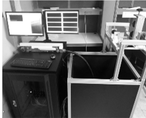
شکل ۱۱. مجموعه نهایی روبات، واحد کنترل و محفظه وینچ
