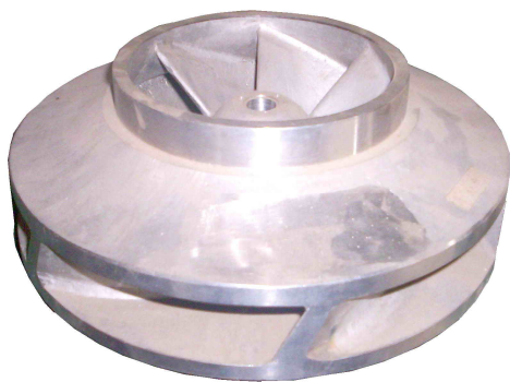
شکل ۱-ب. پروانه استفاده شده در پمپ گریز از مرکز
