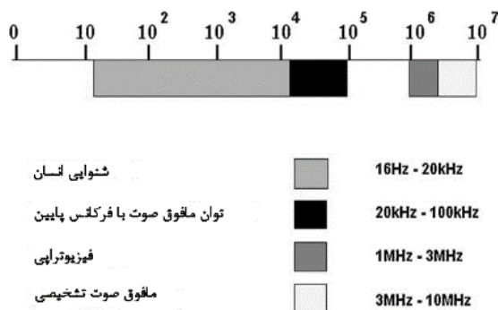
شکل ۱. طبقه‌بندی کلی محدوده فرکانس‌های فراصوت [۱۹]
