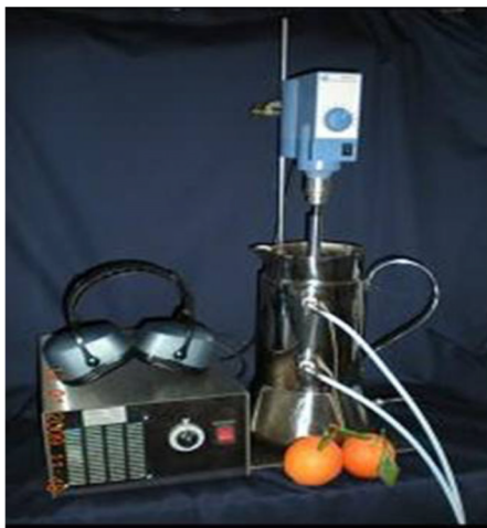
شکل ۶. راکتور آزمایشگاهی استخراج فراصوت
