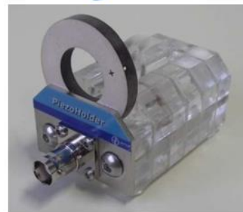
شکل ۵. تجهیزات آزمون؛ (الف) دستگاه تحلیل‌گر امپدانس و (ب) هولدر آزمون پیزوالکتریک [۱۸]
