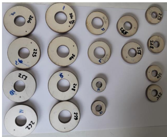
شکل ۴. پیزوالکتریک‌های رینگ شکل رایج در فناوری فراصوتی
