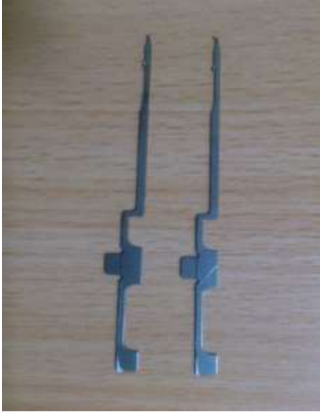
شکل ۹. سوزن‌های شکسته شده ماشین بافندگی Falmac
