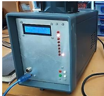
شکل ۱. منبع تغذیه‌ی فراصوت (توان ۱/۵ کیلووات و فرکانس
