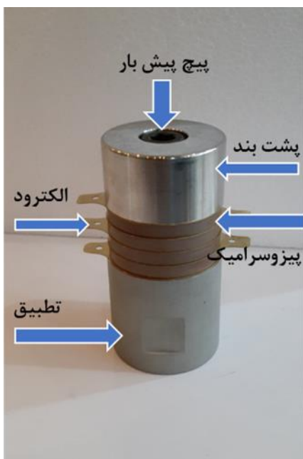
شکل ۲. اجزای اصلی مبدل پیزوالکتریک فراصوتی
