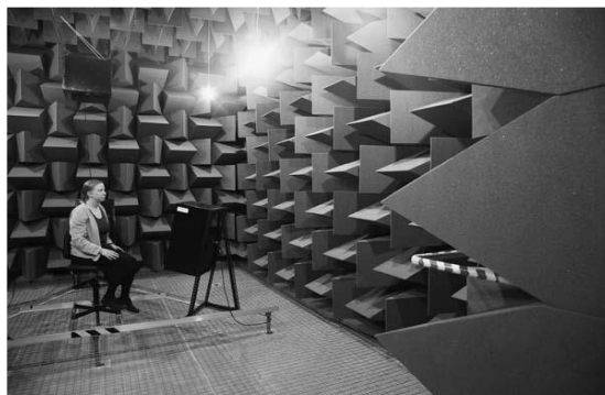
شکل ۴. نمایی از اتاق بدون پژواک به کار رفته در دانشگاه سالفورد انگلستان [۲].
