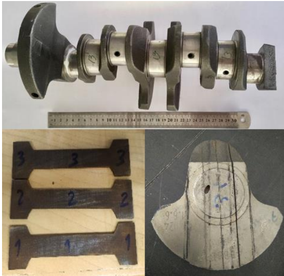
شکل ۱. استخراج نمونه‌های استاندارد از داخل وب میل‌لنگ
