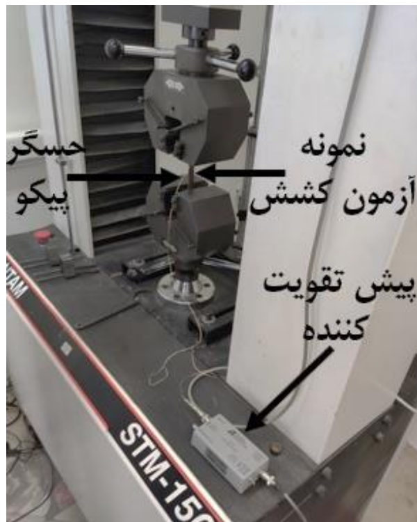
شکل ۳. دستگاه آزمون کشش یونیورسال سنتام مدل STM-150
