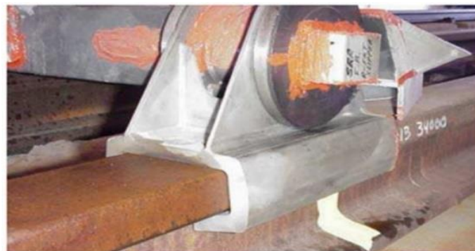
شکل ۶. نحوه اتصال ریل به کفشک [۲۸]
